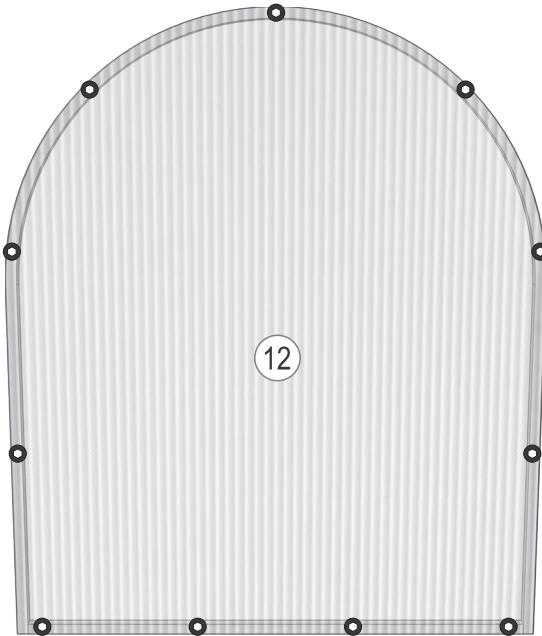
Расположите сотовый поликарбонат (12) на торцевые дуги (1) и закрепите кровельными саморезами 5.5x25 (16) в заводские отверстия согласно рисунку. Слой со светостабилизатором, защищающим структуру листа от воздействия УФ-лучей, имеет сторона с цветной защитной плёнкой или информационной полосой. Эта сторона сотового поликарбоната является наружной и должна быть обращена к солнцу.
