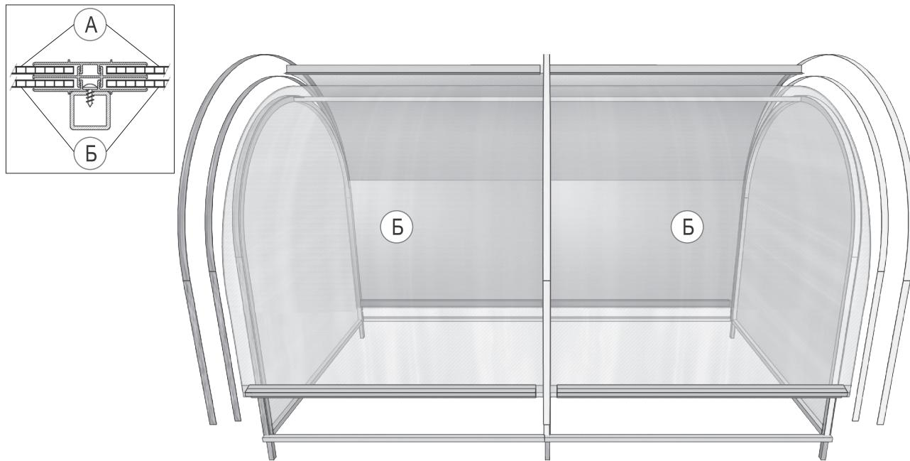
Сдвижную секцию с одной ручкой (Б) вставляем в нижний паз направляющей и сдвигаем на противоположную сторону парника.
