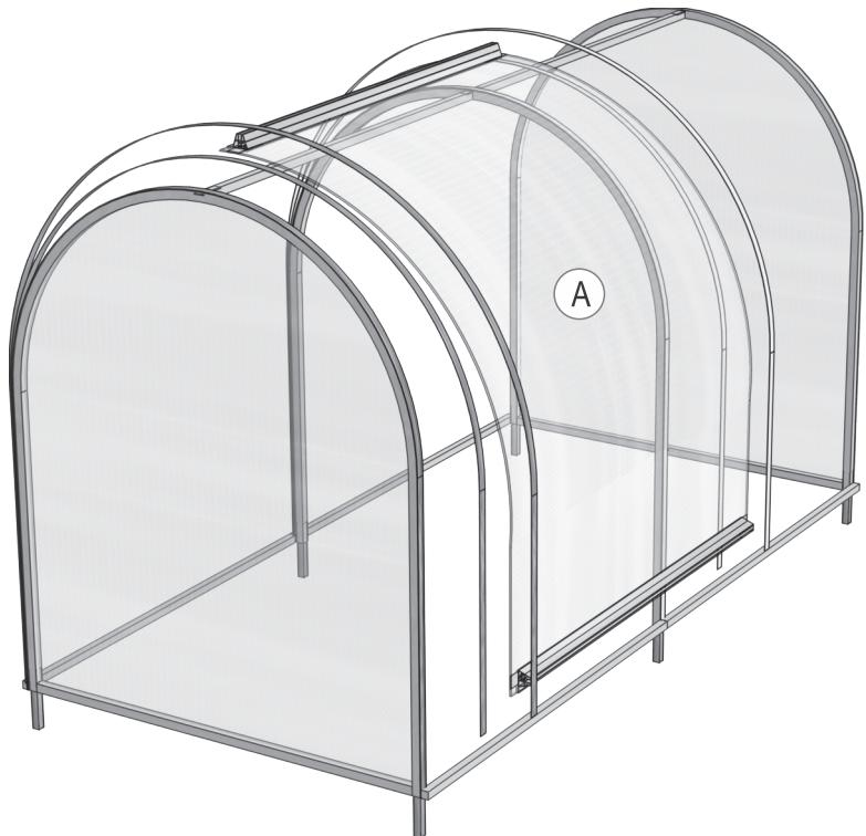
Сдвижную секцию с двумя ручками (А) вставляем в верхний паз направляющей и сдвигаем по направляющей на противоположную сторону парника
